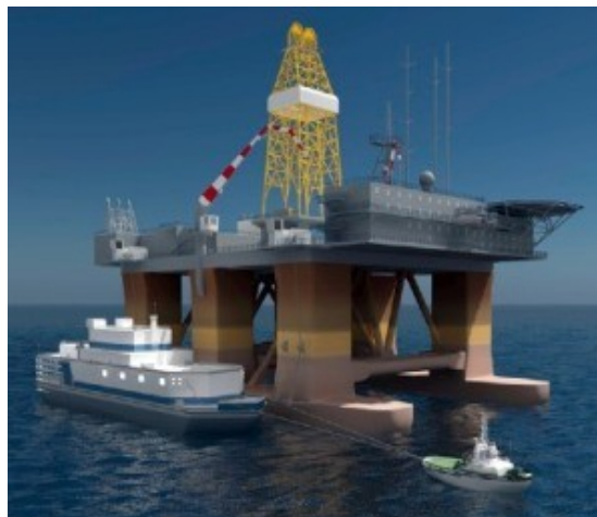
Centrale nucléaire flottante alimentant en eau et en électricité une plateforme pétrolière
