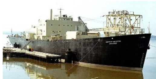
Le Sturgis (MH-1A) - Une centrale nucléaire flottante américaine de 45 MW construite en 1967 par le Génie militaire américain pour approvisionner la zone du Canal de Panama.
